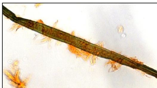
Figura 1c: Tratamiento enzimático (FS1) + refino en PFI (2000 rev)
